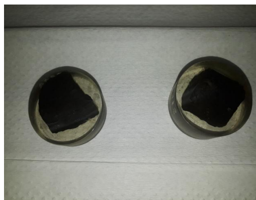
Figura 3.2: Ilustração dos briquetes usados como corpos de prova nos experimentos.
