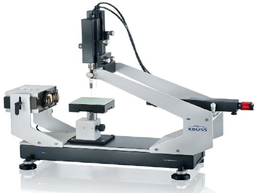
Figura 3.5: Aparato usado para medir tempo de indução (Manual de Procedimentos da KRUSS)
