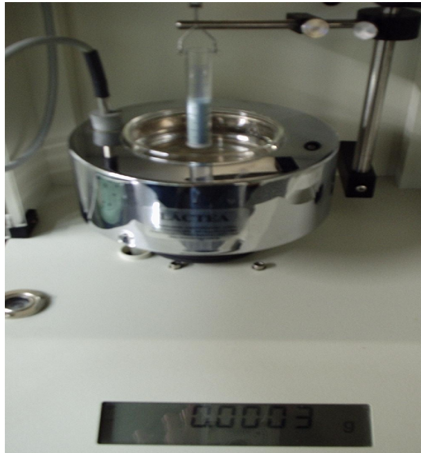
Figura 2.5: Ilustração do método de Washburn para medir ângulo de contacto (MARTINS, 2009).
