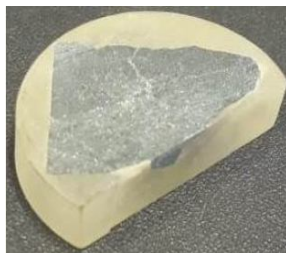
Figura 7 – Ilustração de corpo de prova do mineral hematita com sua respectiva superfície polida.
