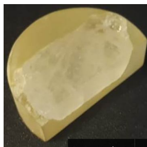
Figura 8 – Ilustração de corpo de prova do quartzo com sua respectiva superfície polida.
